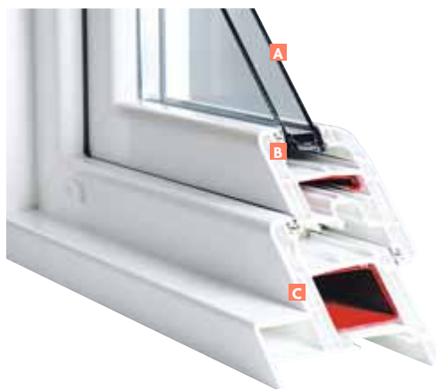
A DOUBLE VITRAGE 4/16/4 ITR B OUVRANT ET C DORMANT : 5 CHAMBRES CHACUN POUR UNE BONNE ISOLATION - RENFORTS EN OPTION (PARTIES ROUGES SUR LA PHOTO)
