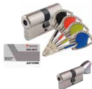
Barillet Axi'Home avec fonction clé de secours, clé incopiable à vie, tige triangulaire à 15 goupilles sur 3 axes, obturateur côté extérieur pour protéger du vandalisme, des intempéries et de la corrosion, inserts en acier anti-perçage, clés fournies en 4 couleurs différentes, anneau ergonomique, barillet fourni avec carte de propriété – 4 clés
